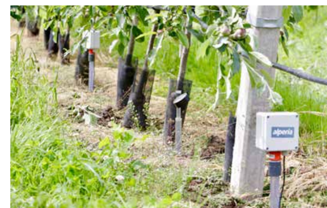
Abb.1: Installierte Bodenfeuchtesensoren im Obstbau zur Messung der Saugspannung im Boden
